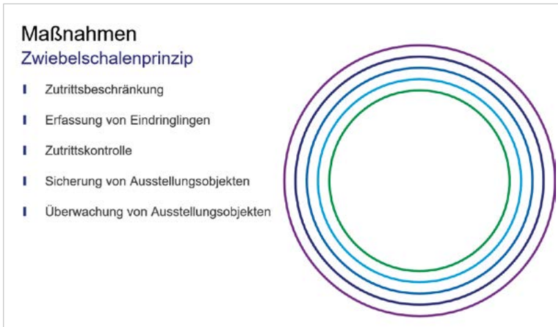
Abb. 2: Sicherheitskonzept nach dem Zwiebelschalenprinzip, verschiedene Sicherungsmaßnahmen von außen nach innen bis zum Schutzgut
